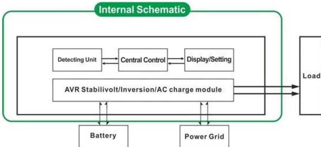
2.1 Утилита первый, батареи в режиме ожидания режим ИБП: ЧАСТОТЫ на ЖК-дисплее устанавливается как 01 Когда оба полезности и батареи подключены к преобразователю., утилита будет подавать питание в нагрузку до батареи. Когда утилита отрезан, батарея автоматически продолжает питать после инверсии.
