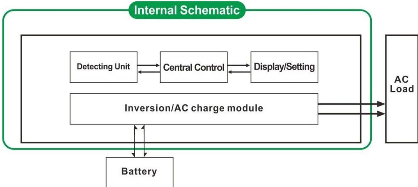
1.1 Нормальный рабочий режим (ON): Независимо от того, это не связано нагрузки переменного тока или не инвертор всегда преобразовывать постоянный ток в переменный. ЖК инвертора отображения выходного напряжения. Потребляемая мощность
