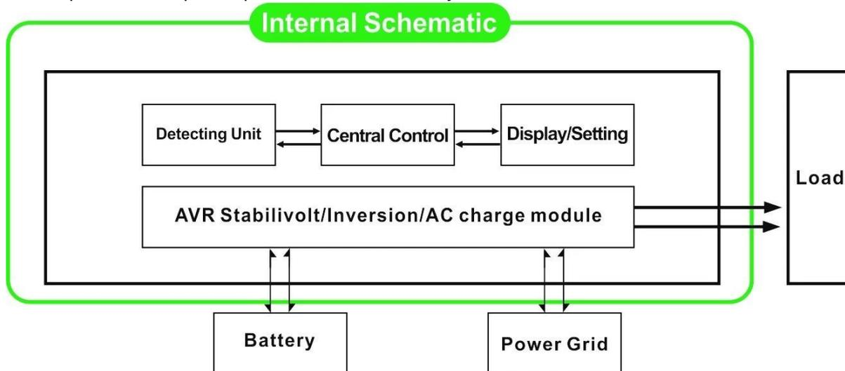
2.1 Утилита первым (AC первым) батареи в режиме ожидания Режим: частота на ЖК-дисплее установлен в 01. Когда утилита и батареи подключены к преобразователю, утилита будет поставлять силу к нагрузкам до. Когда утилита отрезать, батарея будет автоматически продолжает питать с помощью инвертора.
