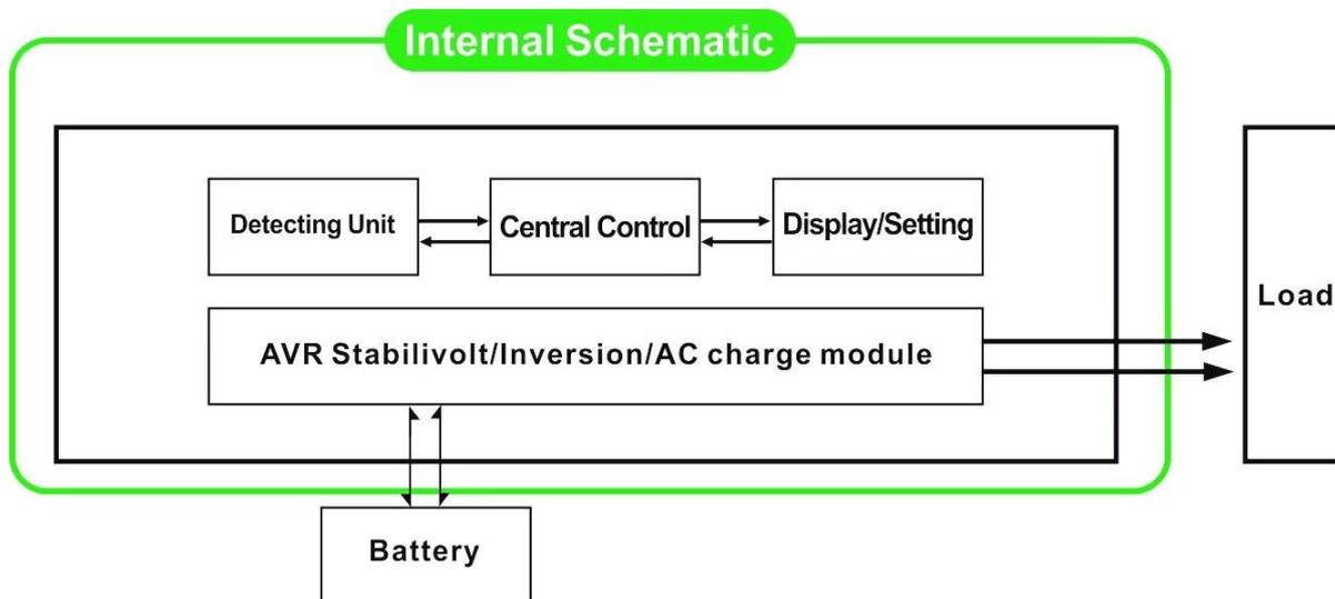
1.1 Нормальный рабочий режим: FREQUENCY на ЖК-дисплее не установлен в 01. Независимо от того, что он подключен нагрузки переменного тока или нет, инвертор всегда преобразовывать постоянный ток в переменный. Она готова для питания нагрузки переменного тока. В этом режиме ЖК-дисплей будет отображать напряжение на выходе, как показано ниже:
