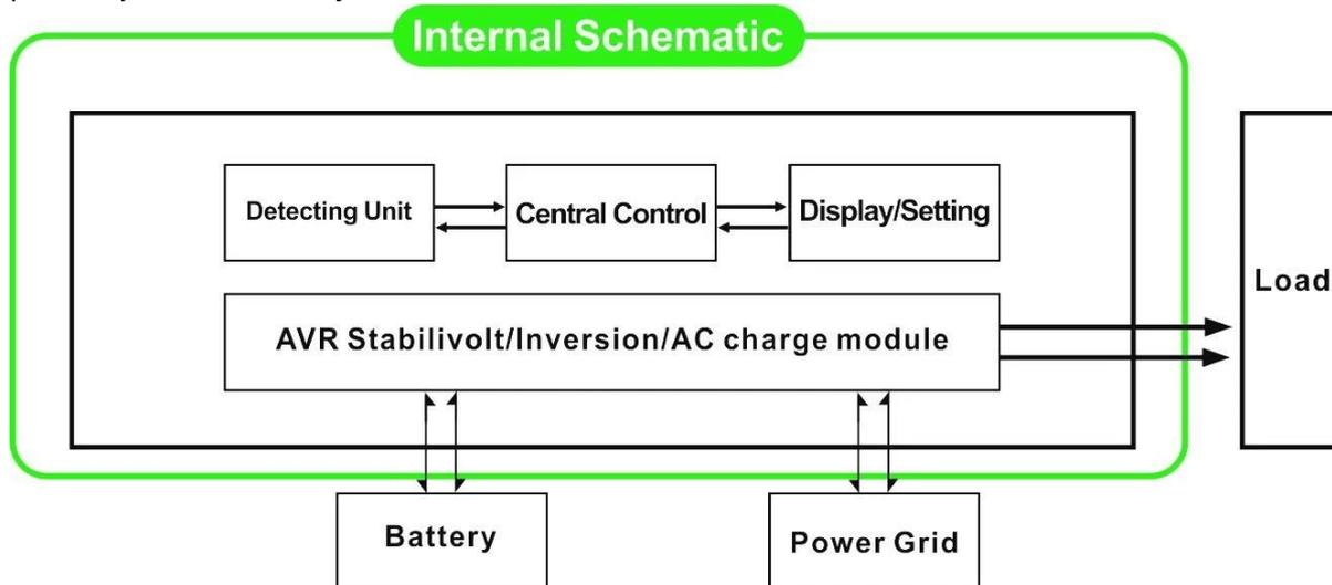
2.1, утилита первый (AC первый) резервный аккумулятор режим: ЧАСТОТЫ на ЖК-дисплее установлено значение 01. Когда утилита и батареи подключены к преобразователю, утилита будет подавать питание на нагрузку до Когда утилита отрезан, аккумулятор. автоматически продолжать подавать питание через инвертор питания.
