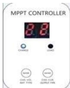
2.1 ENTER1 кнопку: нажмите левую ENTER1 показать 2 цифровой напряжение батареи (если она заряжается, то показывает 2 цифровой напряжение заряда), например, напряжение батареи или напряжение заряда 13,5В, это shows13 см рисунок 2.1; Пресс ENTER1 & NBSP; немного дольше, пользователи могут установить типы батарей.
