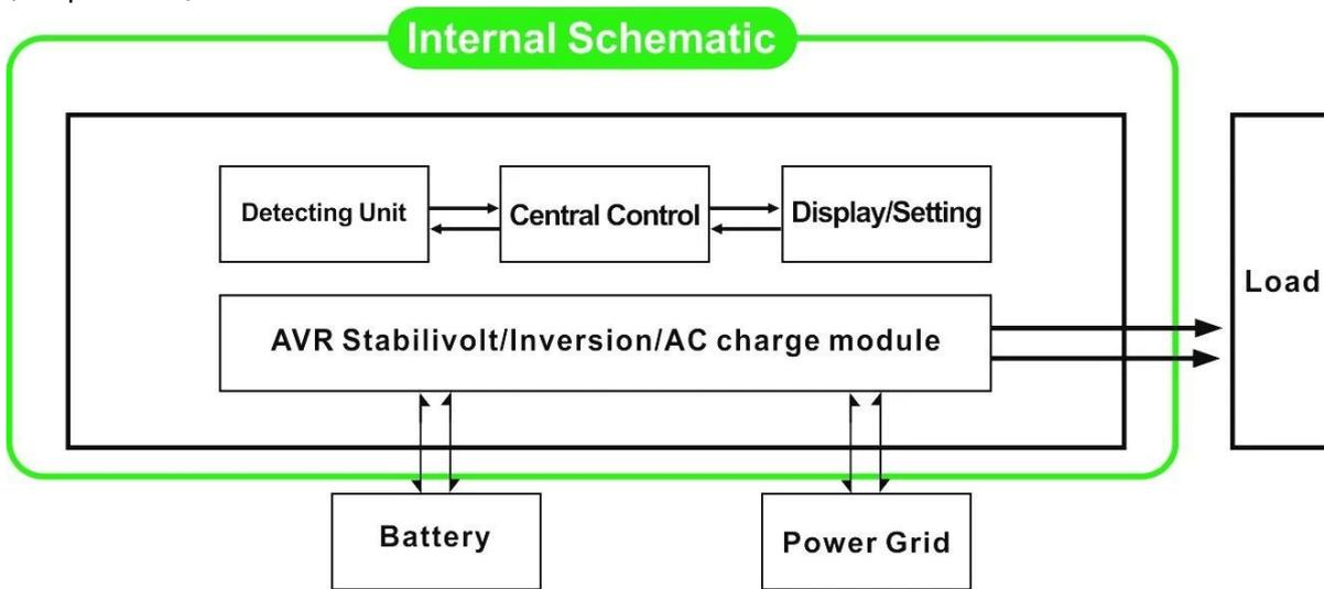
2.1, Utilitário primeiro (CA primeiro) modo de espera de bateria: FREQUÊNCIA na exibição de LCD é ajustada a 01. Quando utilidade e bateria são conectadas ao inversor, utilidade proverá energia às cargas antes Quando utilidade é cortada, a bateria irá. automaticamente continuar a fornecer energia via inversor de energia.
