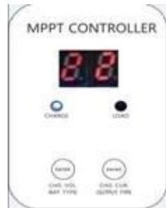
2.1 ENTER1 botão: pressione esquerda ENTER1 mostrar dois voltagem da bateria digital (se for o carregamento, em seguida, mostra 2 tensão de carga digital), por exemplo, a tensão de voltagem da bateria ou carga é 13.5V, ele shows13, por favor, veja a Figura 2.1; Imprensa ENTER1 &nbsp; um pouco mais de tempo, os usuários podem definir tipos de baterias.
