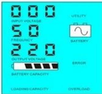
1.2 当检测到输入电压为0V且负载功率大于5%时，逆变器将切换到AC模式，此时逆变器将停止工作，LCD显示如下：
