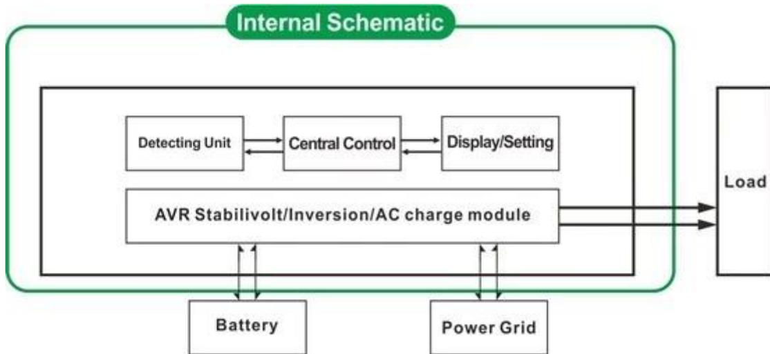
2.1 Utility primo, batteria in standby mode UPS: FREQUENZA sul display LCD è impostato come 01 Quando sia l'utilità e la batteria sono collegati all'inverter., utilità alimentare i carichi prima della batteria. Quando utility è tagliato fuori, la batteria continuerà automaticamente per fornire energia dopo l'inversione.
