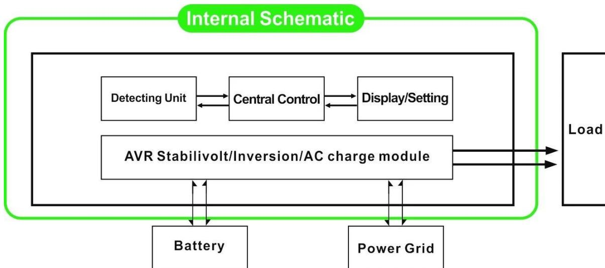
2.1, Utility prima (AC prima) standby batteria Modalità: frequenza sul display LCD è impostato su 01. Quando l'utilità e la batteria sono collegati all'inverter, utilità alimentare i carichi prima volta utility viene interrotta, la batteria. continuerà automaticamente per fornire alimentazione tramite inverter di potenza.
