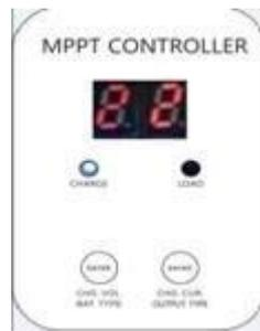
1 ENTER1 tasto: premere il tasto sinistro ENTER1 Mostra 2 tensione della batteria digitale (se si è in carica, poi mostra 2 tensione di carica digitale), per esempio, la tensione della tensione della batteria o di carica è 13.5V, esso shows13, vedere Figura 2.1; Press ENTER1 &nbsp; ; un po 'più a lungo, gli utenti possono impostare i tipi di batterie.
