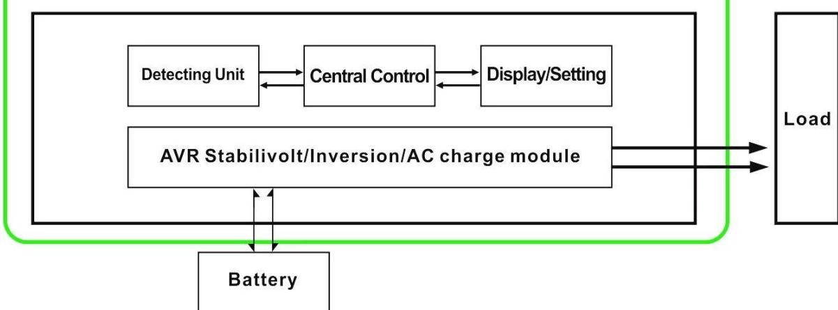
1.1, Κανονική κατάσταση λειτουργίας: FREQUENCY στην οθόνη LCD έχει οριστεί σε 01. Δεν έχει σημασία είναι συνδεδεμένο AC φορτία ή όχι, ο μετατροπέας πάντα να μετατρέψει DC σε AC. Είναι έτοιμη να παρέχει ισχύ στα φορτία εναλλασσόμενου ρεύματος. Σε αυτή τη λειτουργία, η οθόνη LCD θα εμφανίσει τάση εξόδου, όπως παρακάτω:
