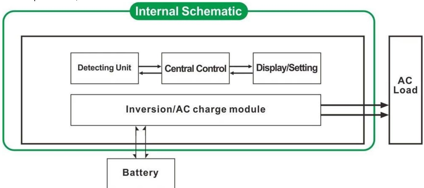
1.1 mode de fonctionnement normal (ON): charges CA Peu importe il est connecté ou pas l'onduleur convertit toujours continu en courant alternatif. Le LCD de l'onduleur afficher la tension de sortie. La consommation d'énergie
