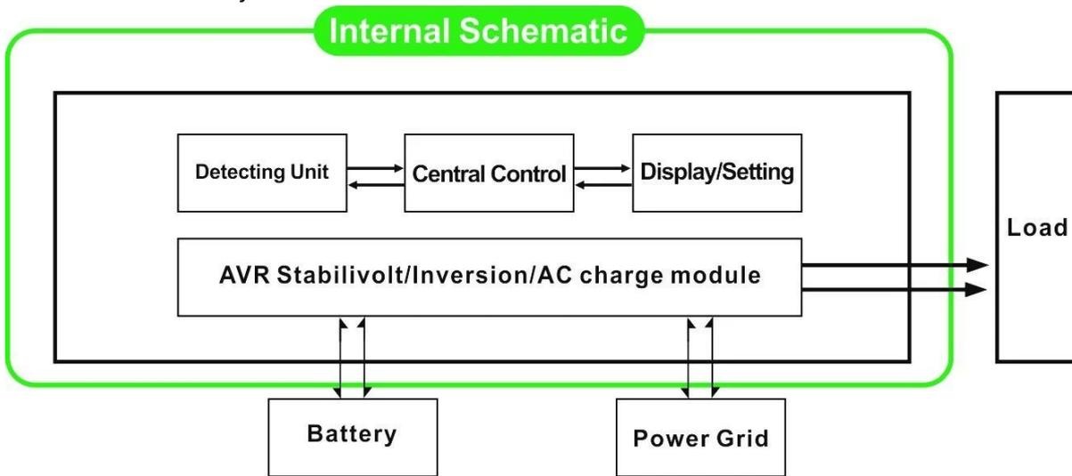
2.1, l'utilitaire premier (AC première) de la batterie en mode de veille: fréquence sur l'écran LCD est réglé sur 01. Lorsque l'utilité et la batterie sont raccordés à l'onduleur, utilitaire alimenter les charges avant. Lorsque l'utilitaire est coupée, la batterie sera automatiquement continuer à alimenter via onduleur.
