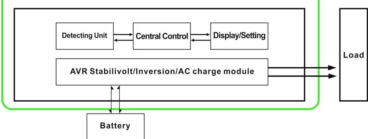
1.1 Normalarbeitsmodus: Frequenzverhältnisses im LCD-Display Egal auf 01 festgelegt ist es AC-Lasten angeschlossen ist oder nicht, der Wechselrichter immer wandeln Gleichstrom in Wechselstrom. Es ist bereit, die Macht an die AC-Lasten zu liefern. In diesem Modus wird die LCD-Anzeige Ausgangsspannung als Gebrüll:
