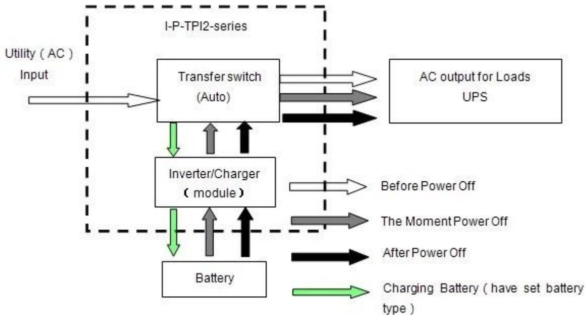
3.2. Режим работы от батарей первый утилита Резервные ИБП (на панели поверните кнопку, чтобы "DC").
