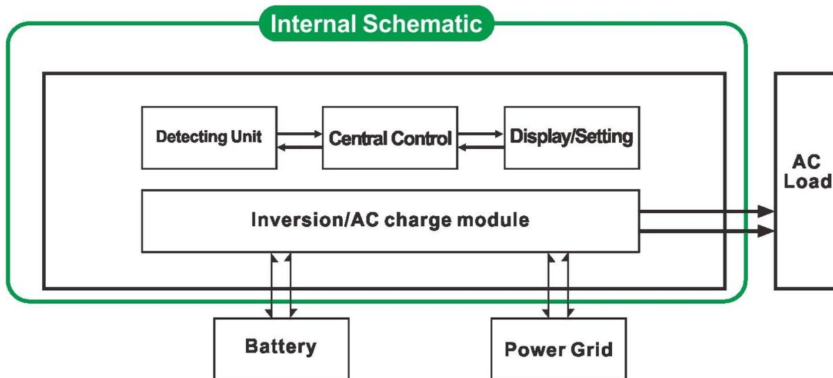
3.1. Утилита первая батарея в режиме ожидания ИБП (на панели поверните ручку "AC")
