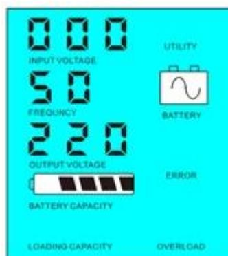
1.2 & NBSP; Спящий режим: Frequncув ЖК-дисплей установлен как 02.If сила подключенных нагрузок переменного тока нижечем на 5% от номинальной мощности инвертора, не будет никакого вывода изинвертор. Только чип преобразователя работает. Потребляемая
