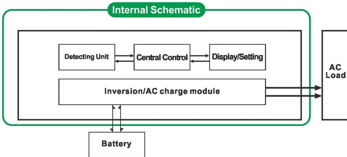
1.1 modo normal de trabalho (ON): cargas CA Não importa o que está conectado ou não o inversor sempre converter DC para AC. O LCD do inversor mostra a tensão de saída. O consumo de energia no modo normal de trabalho é um pouco maior do que no modo sleep
