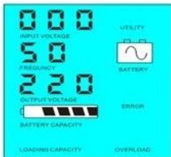
1.2 当检测到输入电压为0V时，频率显示为02，AC输入电压显示为5.00V，LCD显示为000，此时逆变器处于待机状态，当检测到输入电压为1-6V时，频率显示为5S，LCD显示为000
