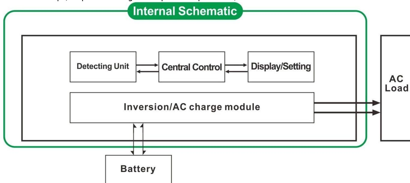
1.1 Modalità di funzionamento normale (ON): carichi AC Non importa è collegato o non l'inverter converte sempre da CC a CA. Il display LCD dell'inverter visualizzare la tensione di uscita. Il consumo energetico
