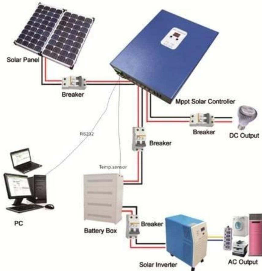
Osservazioni: riconosciuto sistema a batteria DC12V / 24V / 48V automatico.
