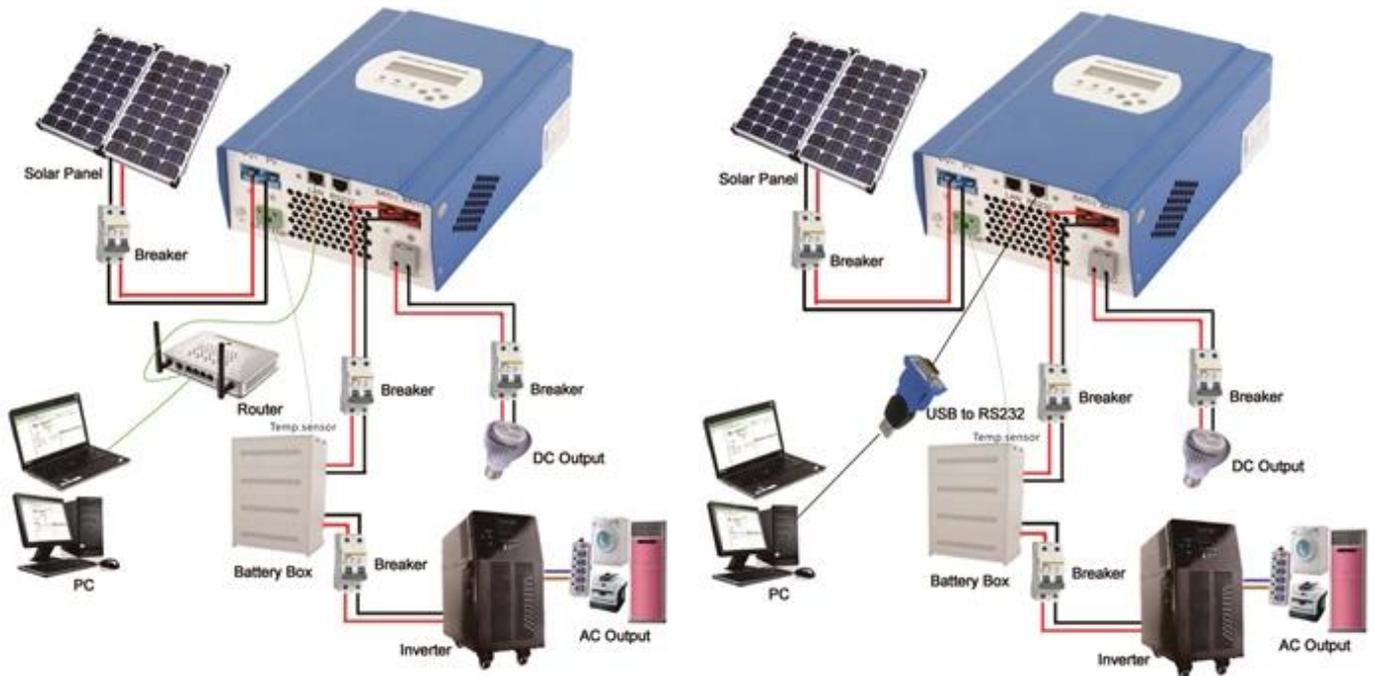
**Σημείωση:** 1) Πάνω απ 'είναι εκτός δικτύου σύνδεσης ηλιακού συστήματος εικόνα?
