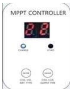
2.1 ENTER1 κουμπί: πατήστε αριστερά ENTER1 δείχνουν 2 ψηφιακή τάση της μπαταρίας (αν φορτίζει, τότε δείχνει 2 ψηφιακές τάση φόρτισης), για παράδειγμα, η λεκτρική τάση της μπαταρίας ή η επιβάρυνση είναι 13.5V, αυτό shows13, παρακαλούμε δείτε το Σχήμα 2.1? Press ENTER1 &nbsp; λίγο περισσότερο, οι χρήστες μπορούν να ορίσετε τους τύπους μπαταριών.
