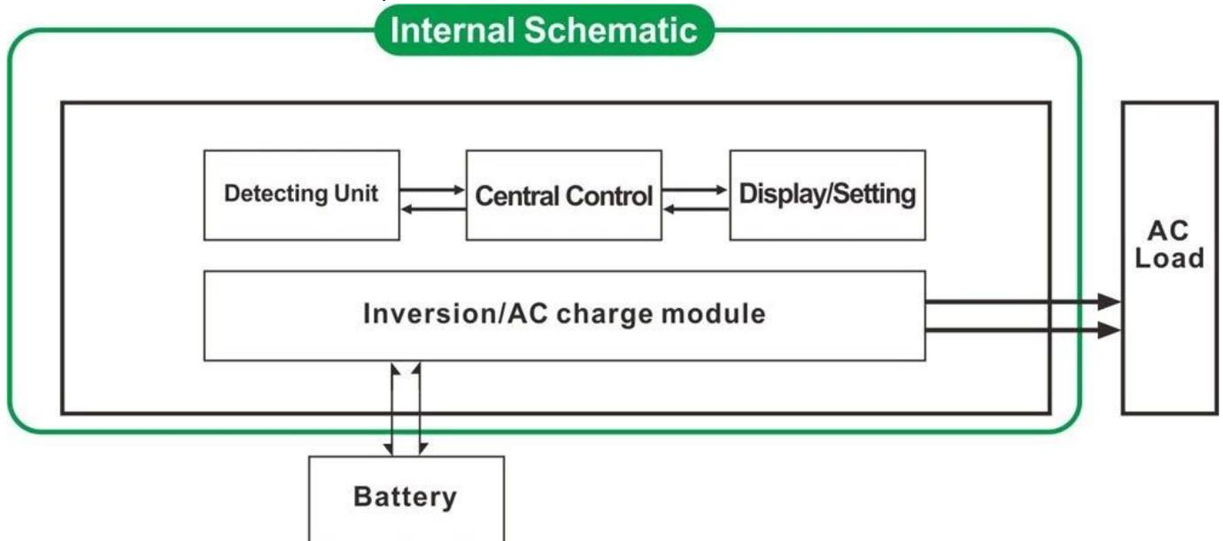
1.1 mode de fonctionnement normal (ON): charges CA Peu importe il est connecté ou pas l'onduleur convertit toujours continu en courant alternatif. Le LCD de l'onduleur afficher la tension de sortie. La consommation d'énergie en mode de fonctionnement normal est un peu plus élevé que dans le mode de sommeil
