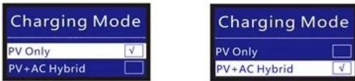
1.1 PV charger la batterie, l'utilité de ne pas: quand PV et l'utilité sont tous deux connectés à la machine, seul le PV chargera la batterie quand il ya du soleil
