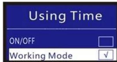
3.1 sincronizados en modo normal modo de trabajo y el sueño / apagado: puede establecer una hora concretas para abrir la salida normal y cuándo cerrar la salida de CA para entrar en modo de suspensión.
