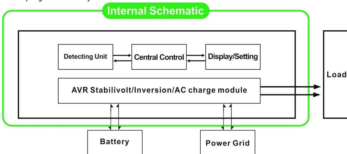
2.1, Dienstprogramm zuerst (AC zuerst) Batterie Standby-Modus: Frequenz in der LCD-Anzeige auf 01 gesetzt wird, wenn Netz- und Batteriebetrieb an den Wechselrichter angeschlossen sind, wird Dienstprogramm vor Energie an die Verbraucher liefern. Wenn die Netz abgeschnitten wird, weiterhin wird die Batterie automatisch die Stromversorgung über Power Inverter zu versorgen.
