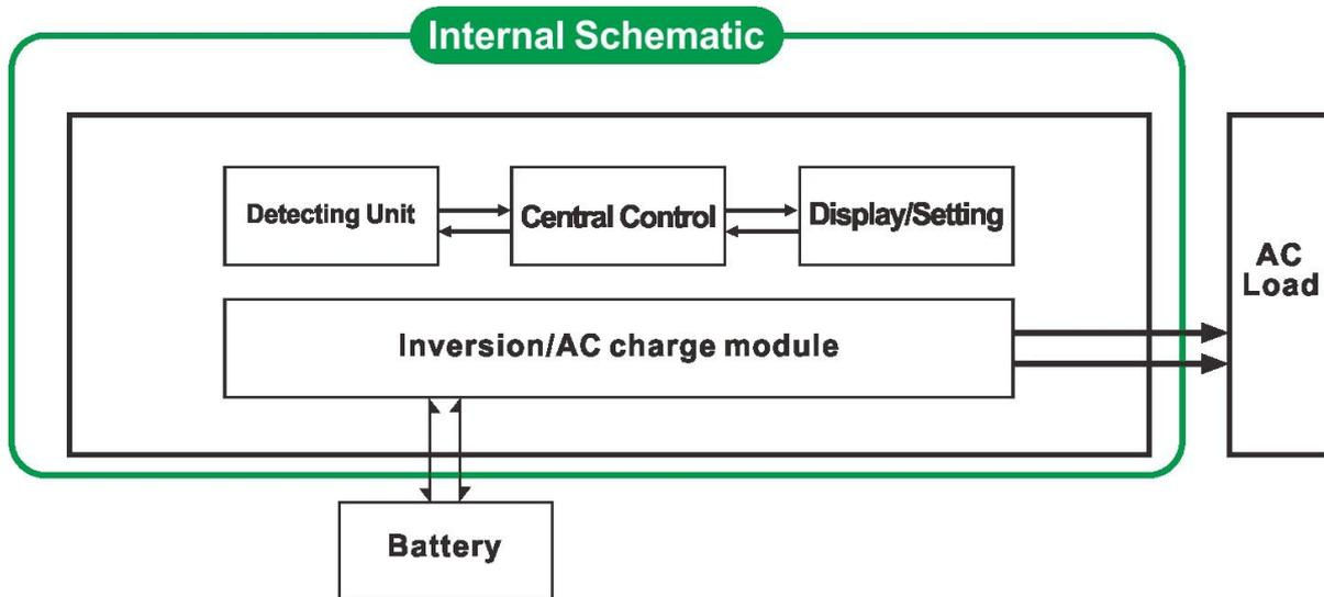
1.1 Normalarbeitsmodus (ON): Egal, er angeschlossen ist AC-Lasten oder nicht der Wechselrichter immer konvertieren Gleichstrom in Wechselstrom. Die LCD der Wechselrichter zeigt die Ausgangsspannung. Der Energieverbrauch in der normalen Arbeitsmodus ist ein wenig höher als im Ruhezustand
