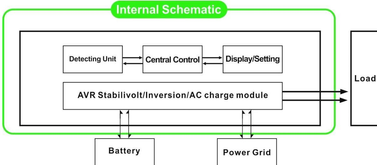
2.1, Dienstprogramm ersten (AC zuerst) Batterie Standby-Modus: Frequenz in der LCD-Anzeige auf 01 festgelegt ist, wenn Netz- und Batteriebetrieb sind mit dem Wechselrichter verbunden, Dienstprogramm Stromversorgung der angeschlossenen vor liefern. Wenn die Netz abgeschnitten ist, wird der Akku automatisch weiterhin Strom über Wechselrichter zu versorgen.
