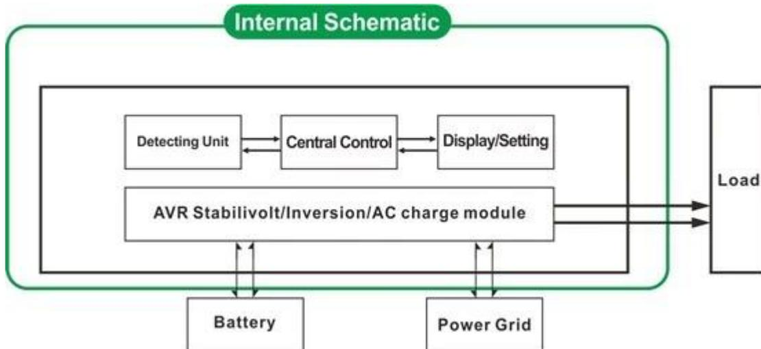
2.1-Dienstprogramm zunächst Akku Standby-UPS Modus: . Frequenz in der LCD-Anzeige wird als 01 gesetzt, wenn beide Versorgungs- und Batterie an den Wechselrichter angeschlossen, Dienstprogramm Stromversorgung der angeschlossenen vorlieferndie Batterie. Wenn die Netz abgeschnitten wird, wird die Batterie automatisch fortgesetztan die Macht nach der Inversion zu versorgen.
