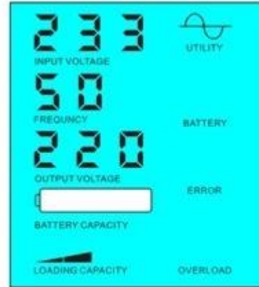
蓄电池没电的时候，由市供电给负载
