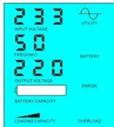
蓄电池没电的时候,由市供电给负载
