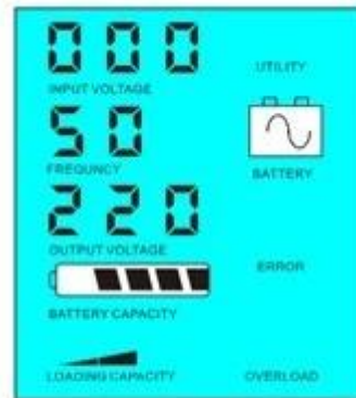
没有市电时为, 逆变为负载供电
