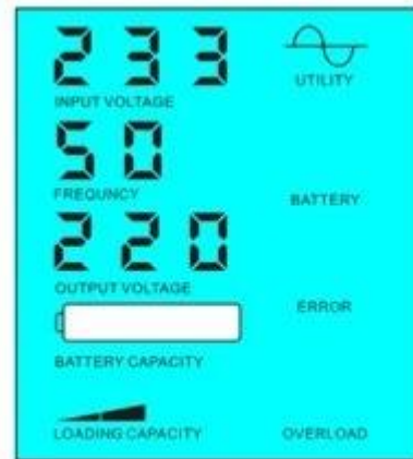
蓄电池没电的时候，由市供电给负载
